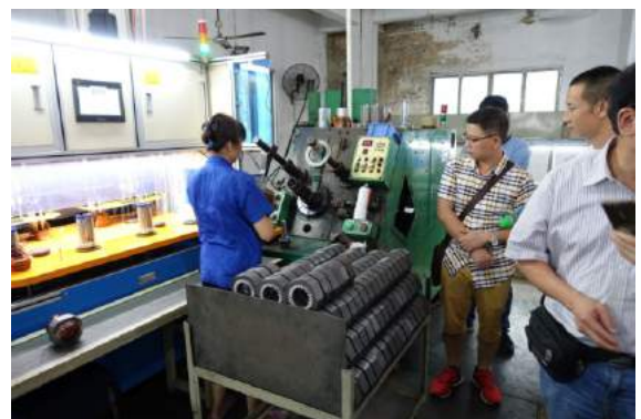
銅線嵌入機芯由機械來工作，確保馬達轉子質量。
