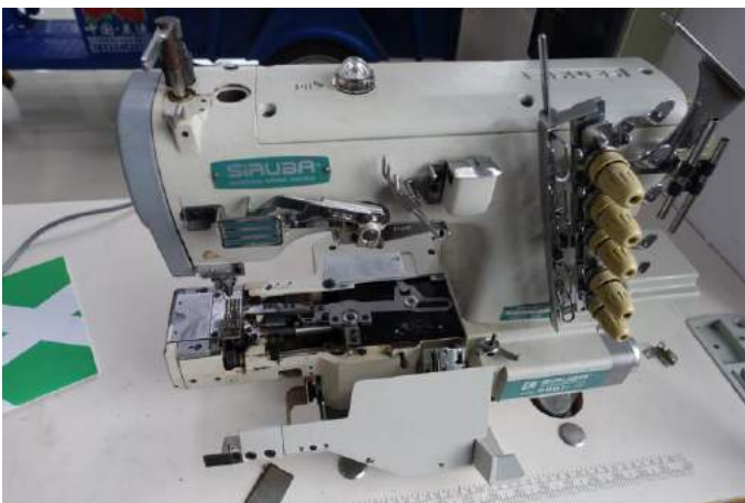
吳仕勝正為一台台灣銀箭牌特種衣車加裝專利的自動剪線系統。
