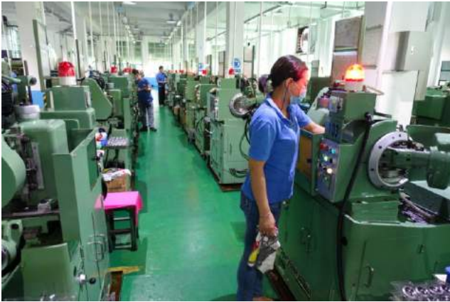
由 50 名工人編制的自動切齒機加工生產線車間，一名工人可監控 5 台機械，車間光線充足，工作環境良好。
