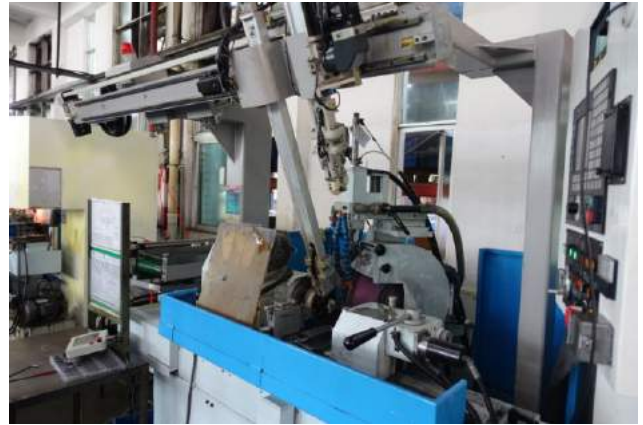
散齒車間加工直立圓柱形齒輪，大部份母機加裝機械臂送料，加工效率大大提高，是鈞興通過技術改造的新成果。
