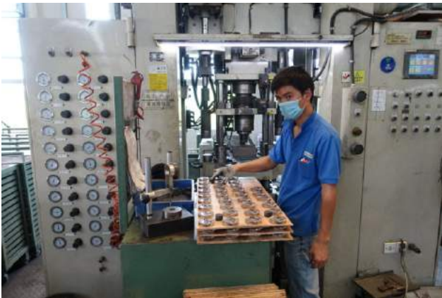
金屬粉末成形工序是其中一個車間重要生產組成部份，操作工人從模具取出成形的電動工具齒輪，每班每天可生產 4000 個。所有產品還需要在高溫爐熱處理，增加齒輪的硬度。
