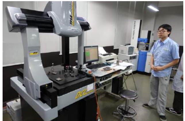
檢測中心全套進口檢測儀器，這是一台座標量度機械，精密齒輪須抽樣檢測，確保精度和質量。
